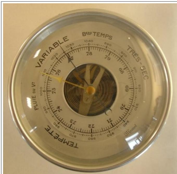
Un baromètre mécanique. La capsule centrale se déforme en fonction de la pression atmosphérique, ce qui fait tourner l'aiguille noire.
